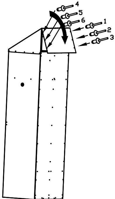
1. Далее необходимо согнуть полотно наклонной крыши по линии перфорации.
