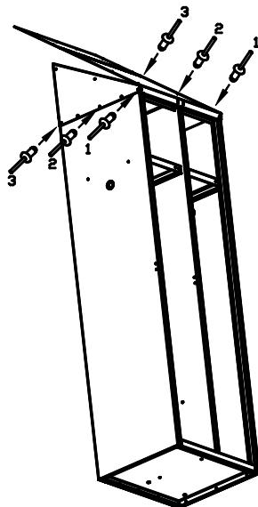
1. При сборке локеров с наклонной крышей, стандартную крышу необходимо прикреплять только на четыре заклепки в углах с лицевой и задней стороны.
