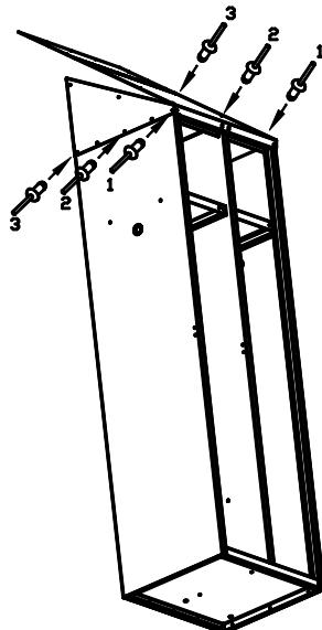
1. При сборке локеров с наклонной крышей, стандартную крышу необходимо приклепать только на четыре заклепки в углах с лицевой и задней стороны.
