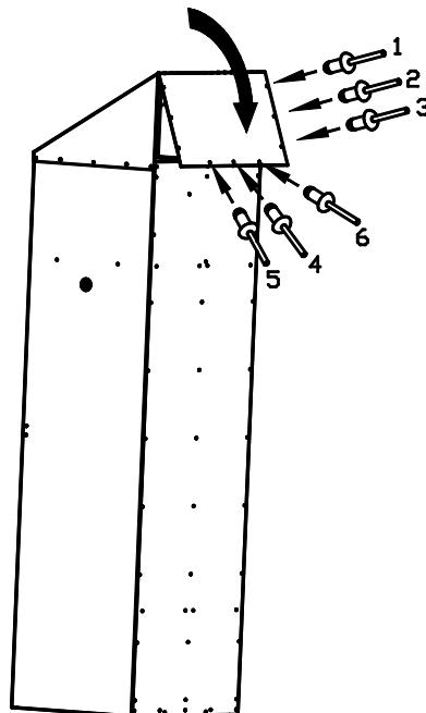
1. Далее необходимо согнуть полотно наклонной крыши по линии перфорации.
